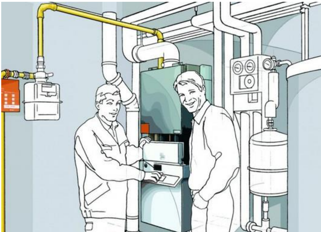
Abbildung 6: Heizungsbauer bei der Inspektion einer Gastherme
